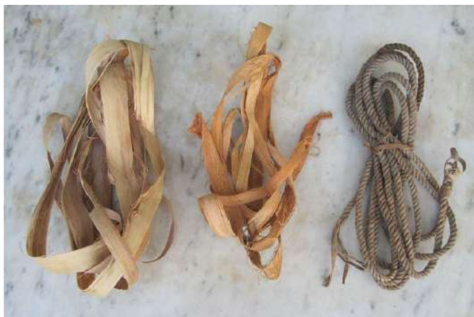
Figura 28: Fotografía en que se ve de izquierda a derecha: sapán de bototillo, sapán de jaile y cuerda elaborada con sapán de jaile 196 .
