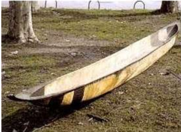
Figura 5: Canoa de un solo tronco fabricada por indígenas de la comunidad cayapa en la costa norte de Ecuador 71 .
